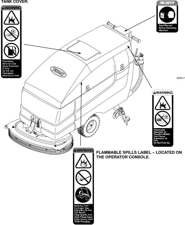
BATTERY CHARGING LABEL - LOCATED ON THE UNDERSIDE OF THE SOLUTION TANK.
